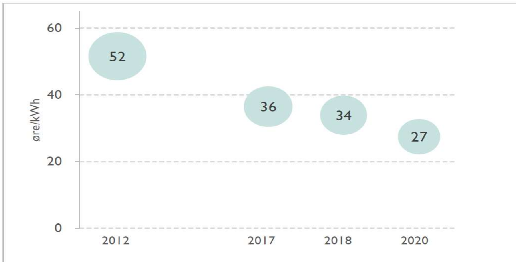
Figur 13: Utvikling i produksjonskostnad over levetid for norske vindkraftverk. LCOE for 2020 er basert på en prognose. Kilde: NVE.
