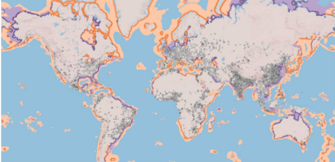
Figur 2-3: Det tekniske potensialet for havvind i verden. Kartet viser områder med et potensial på dypt vann (oransje farge) og grunt vann (lilla farge). Mørk farge er nær kysten og lys farge er langt fra kysten. Kilde: IEA (2019)
